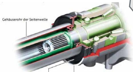
Dieser doppelte Wellendichtring trennt den Ölhaushalt des Vorderachsgetriebes vom Ölhaushalt des Verteilergetriebes.
